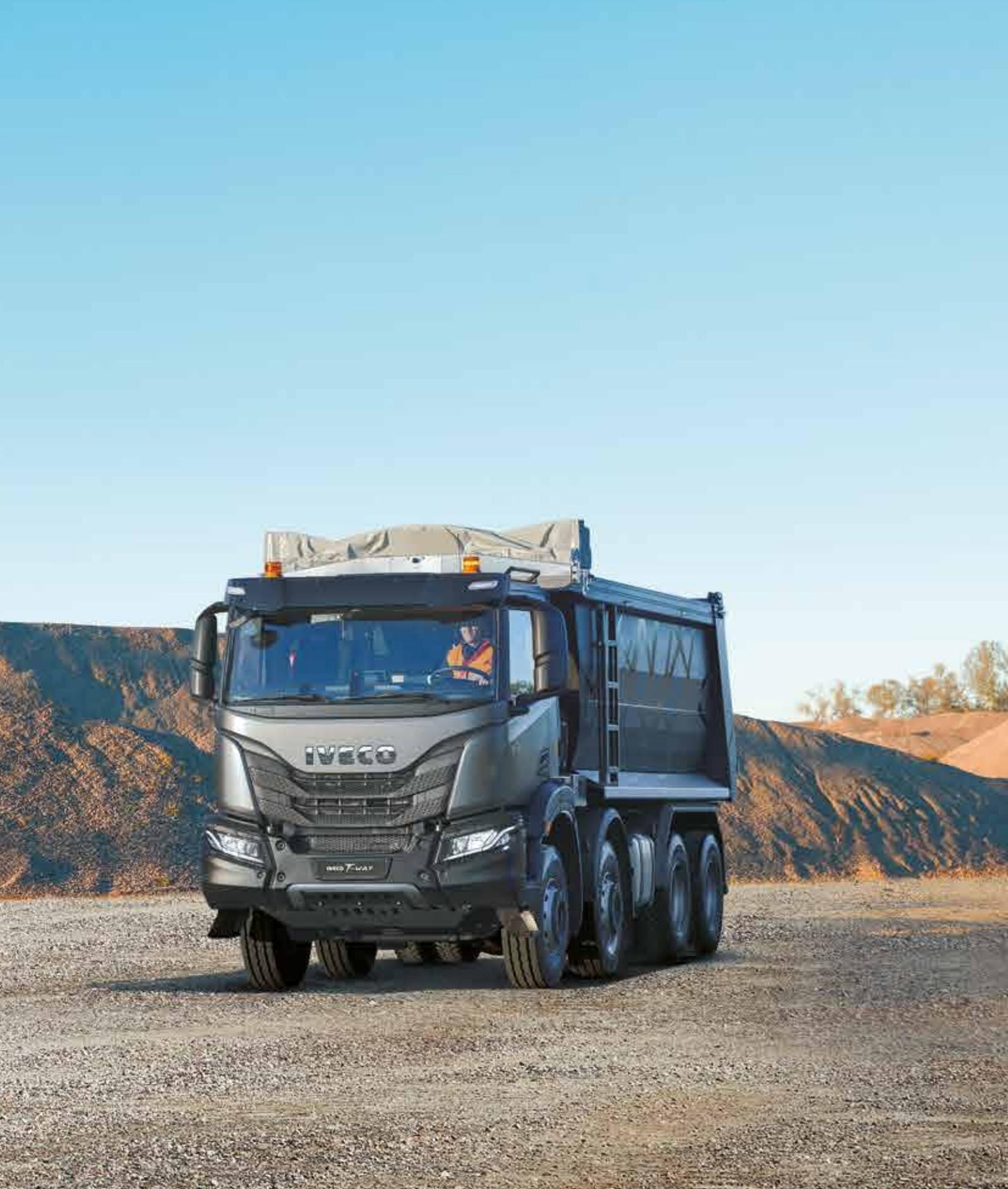
Die neuen Hinterachsen und die neu konzipierte Luftfederung für Tandemachsen wurden unter härtesten Bedingungen getestet. Die Überarbeitung einer Reihe von Komponenten trägt zu einer Leergewichtsoptimierung von bis zu 500 kg bei und erhöht so die Nutzlastkapazität des IVECO T-WAY.
